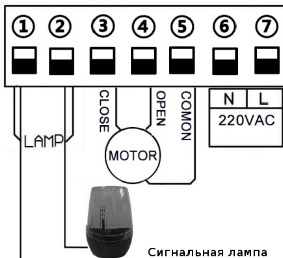
Рис. 10. Подключение сигнальной лампы
